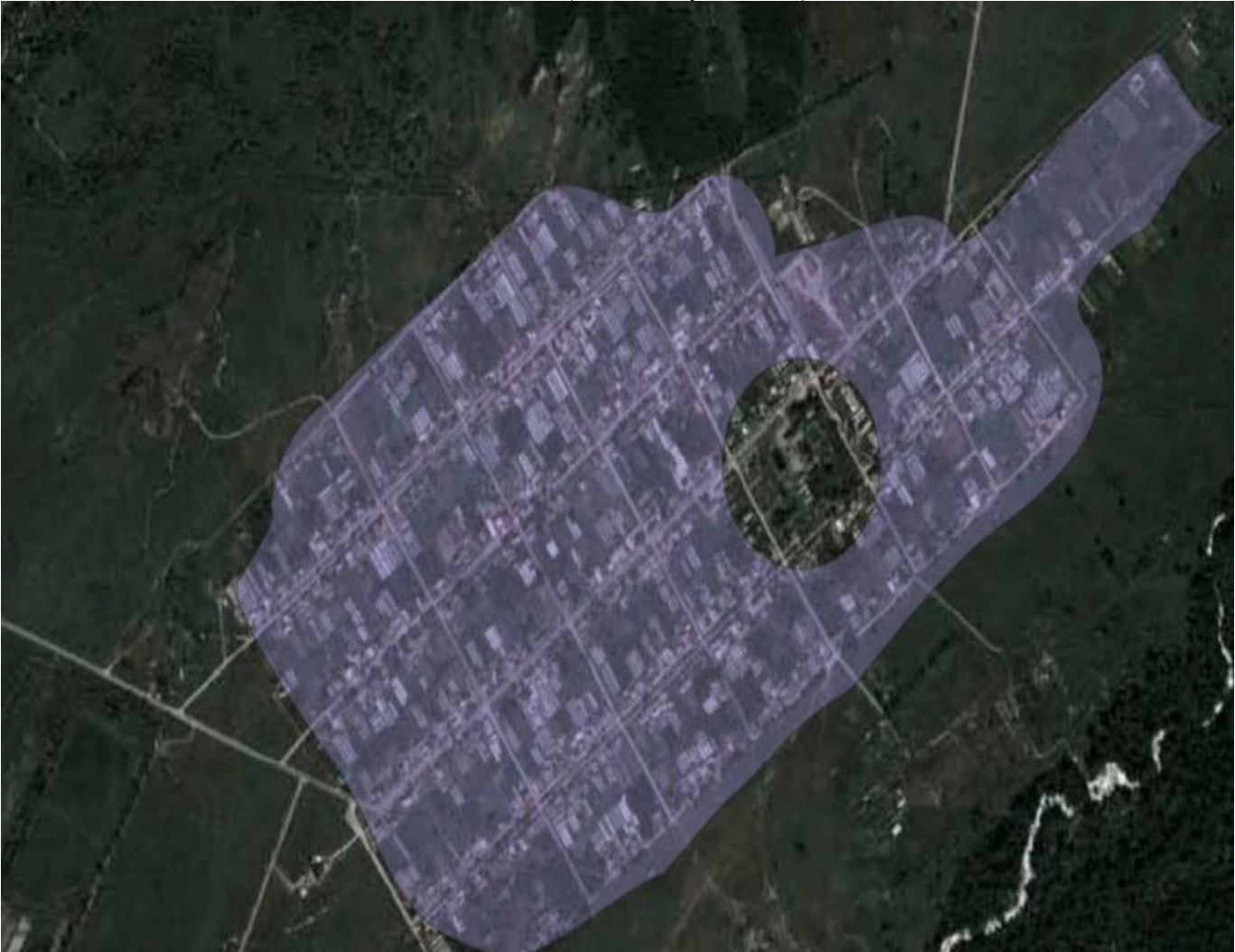
Рис. 2. Зоны действия локальной (индивидуальной) системы теплоснабжения
