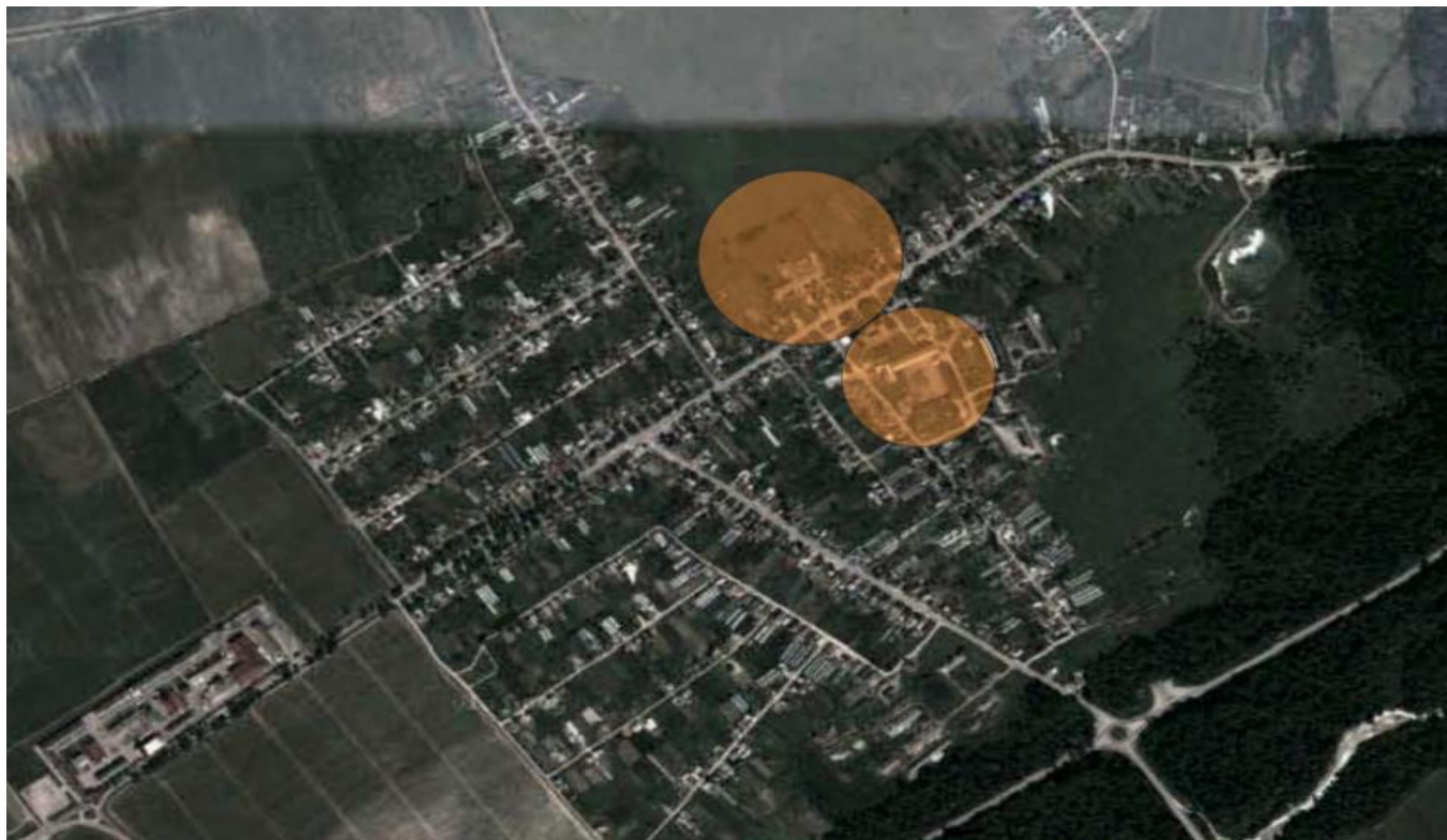
Рис. 1. Зоны действия централизованных источников теплоснабжения
