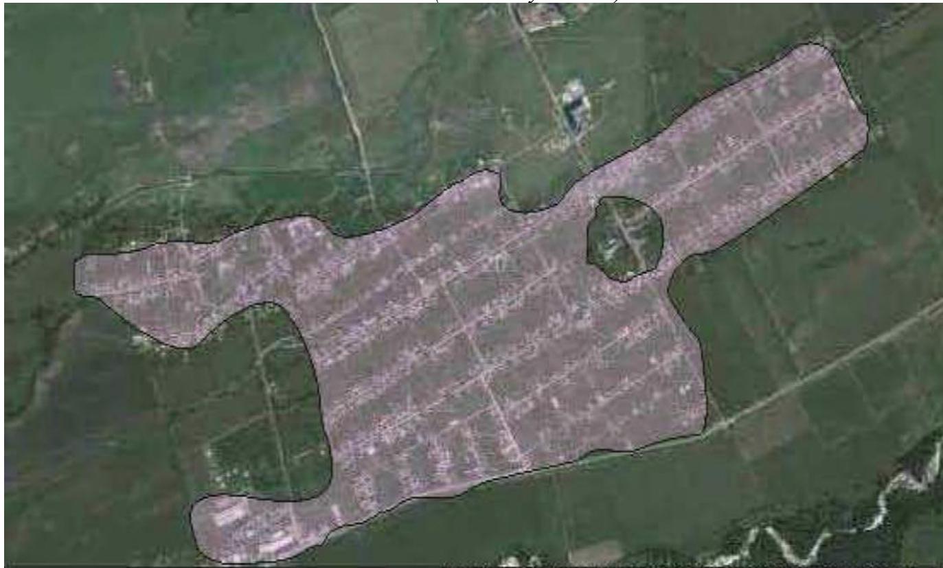
Рис. 2. Зоны действия локальной (индивидуальной) системы теплоснабжения
