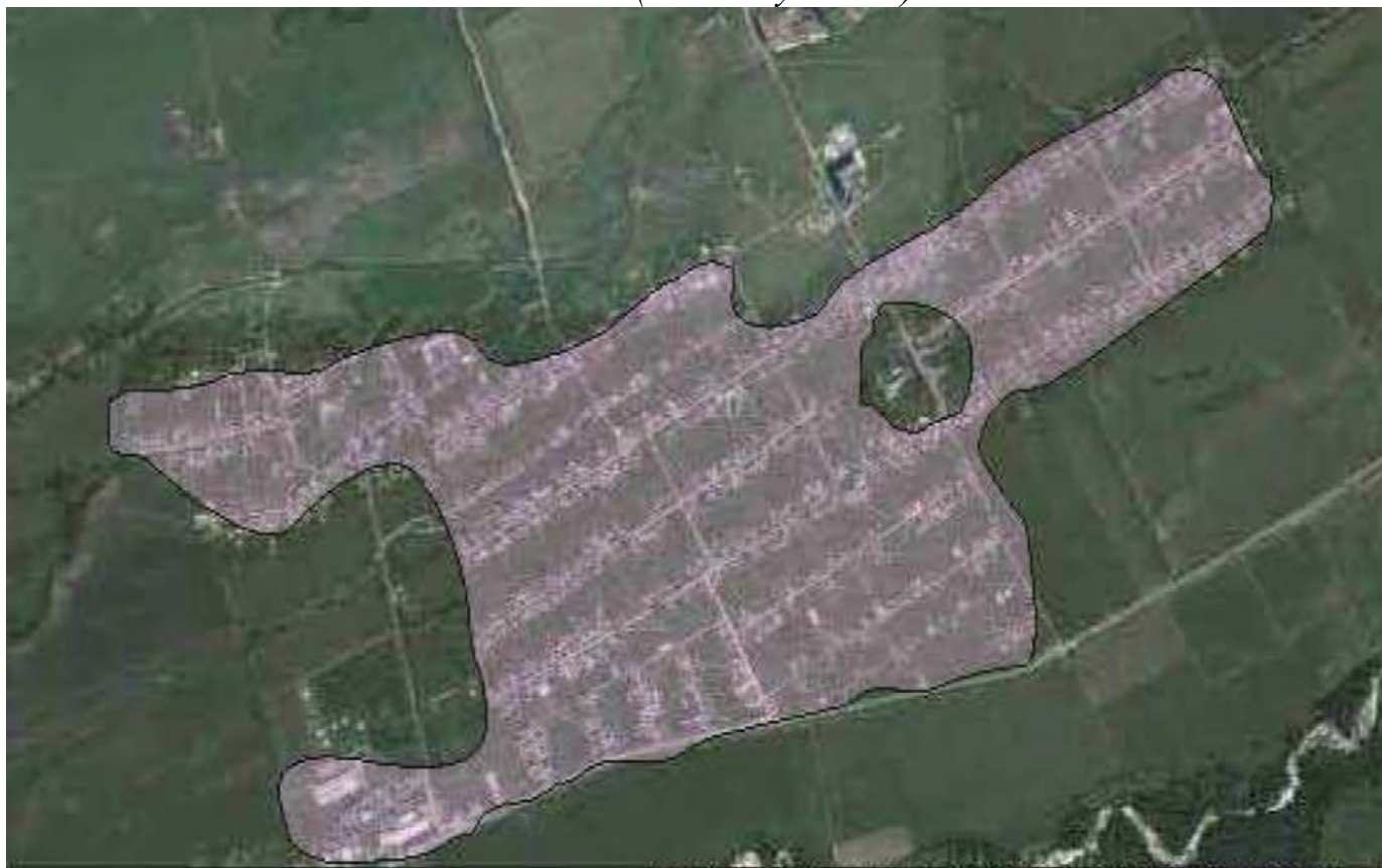
Рис. 2. Зоны действия локальной (индивидуальной) системы теплоснабжения
