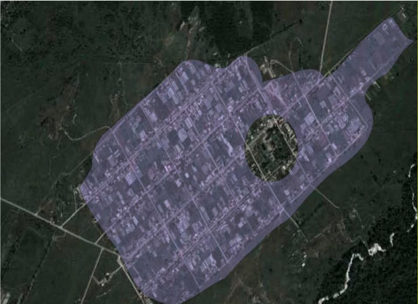
Рис. 2. Зоны действия локальной (индивидуальной) системы теплоснабжения
